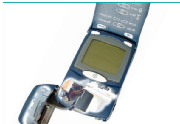
Flexible Leiterplatte in Blutzuckermessgerät Flexible printed circuit in blood glucose meter device
