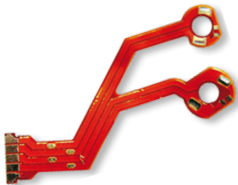
Flexible Leiterplatte in Blutzuckermessgerät Flexible printed circuit in blood glucose meter device
